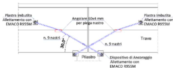
Figura 28 – Tipologico di intervento di connessione pilastro-trave.
