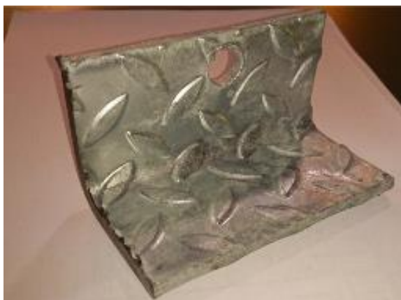
Figura 11 - L'angolare con lavorazione interna mandrolata
