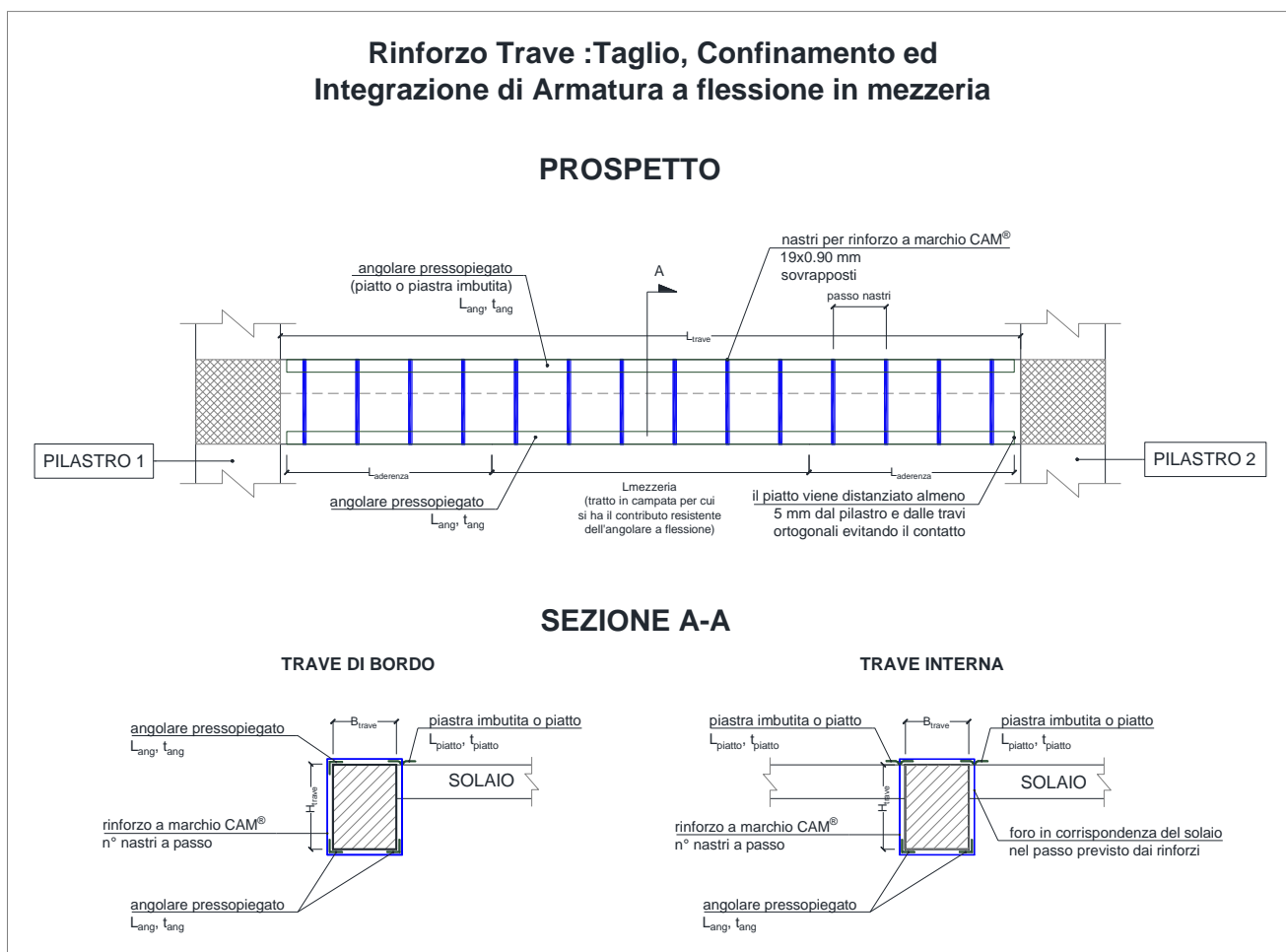
Fig. 60 - Dettaglio intervento di rinforzo della trave a flessione nella sezione di mezzeria.
